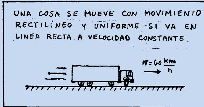
En el MRU la velocidad no cambia, se mantiene constante. Al ser la velocidad todo el tiempo la misma, lo que se viene moviendo **no acelera**. Es decir, en el movimiento rectilíneo y uniforme **la aceleración es cero** ( $a = 0$ ).
