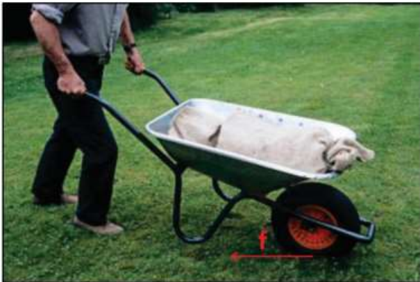
Figura 1. Empujando una carretilla; el contacto entre la rueda con la grama produce una fricción.
